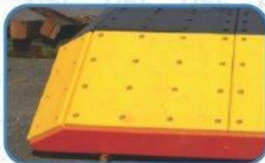
Los paneles además llevan en su cara exterior, la que va en contacto con el casco de la nave, material de baja fricción, en placas empernadas, conocido como UMHW-PE.
